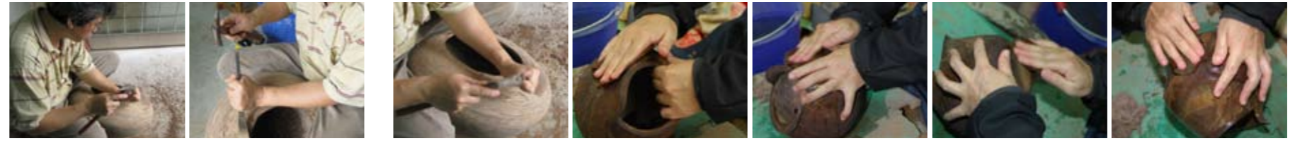
雕刻粗坯之1 雕刻粗坯之2 雕刻粗坯之3 粗水砂紙研磨之1 粗水砂紙研磨之2 粗水砂紙研磨之3 粗水砂紙研磨之4
