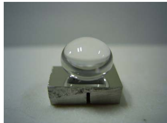
圖十、在氮氣環境下 N-PK51 玻璃球經長時間(30 hrs or 5400 shots)與鍍 Pt/Ir 貴金屬多層膜之基板接觸試驗後之外觀。
