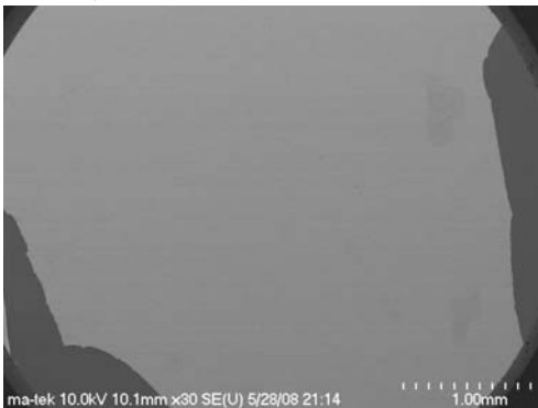
圖六、鍍貴金屬膜層之 Si 晶片與 N-PK51 玻璃球沾黏情形。
