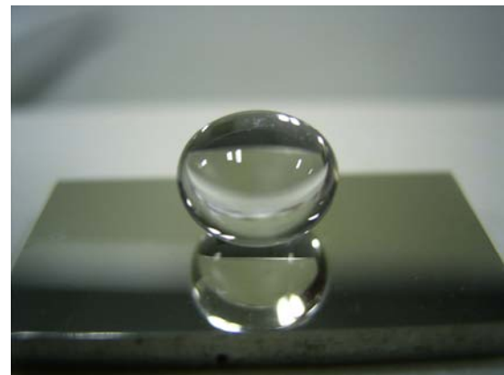
圖九、在氮氣環境下 P-SK57 玻璃球經長時間(30 hrs or 5400 shots)與鍍 Pt/Ir 貴金屬多層膜之基板接觸試驗後之外觀。
