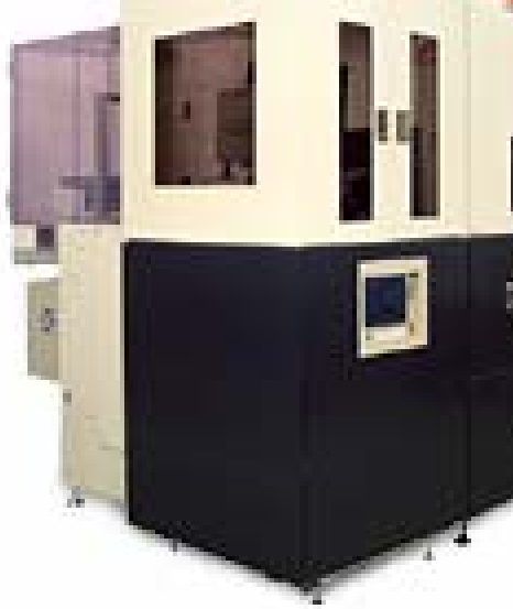
圖二 Toshiba 公司發展之一模多穴單站式玻璃模造機結構示意圖。
