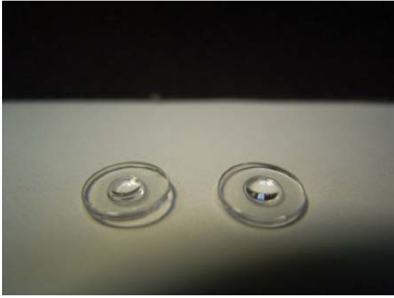
圖十三、對 P-SK57 及 N-PK51 光學玻璃進行模造，模造 800 道次後鏡片取出觀察外觀。
