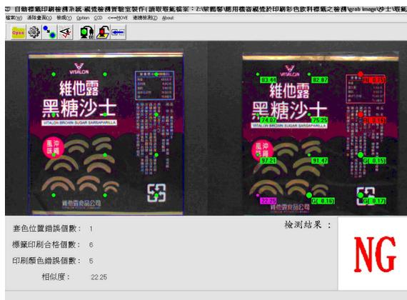
圖十一、黑糖沙士樣本檢測結果畫面：左圖為金標籤影像；右圖為具有色彩瑕疵之標籤影像。
