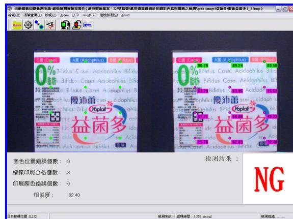
圖八、益菌多樣本檢測結果畫面：左圖為金標籤影像；右圖為具有套色瑕疵之標籤影像。
