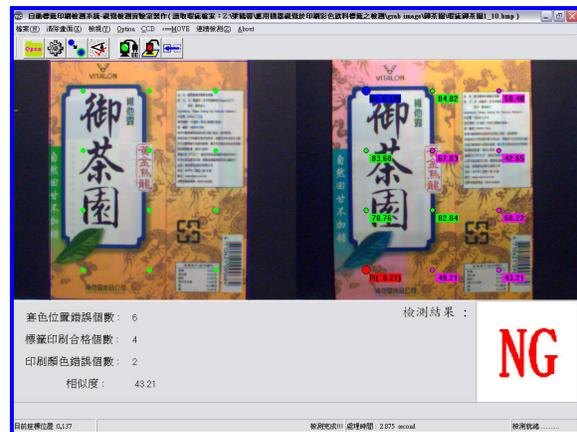
圖十、御茶園樣本檢測結果畫面：左圖為金標籤影像；右圖為具色彩瑕疵之標籤影像。
