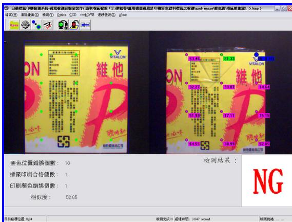
圖九、維他露 P 樣本檢測結果畫面。左圖為金標籤影像；右圖為具套色瑕疵之標籤影像。
