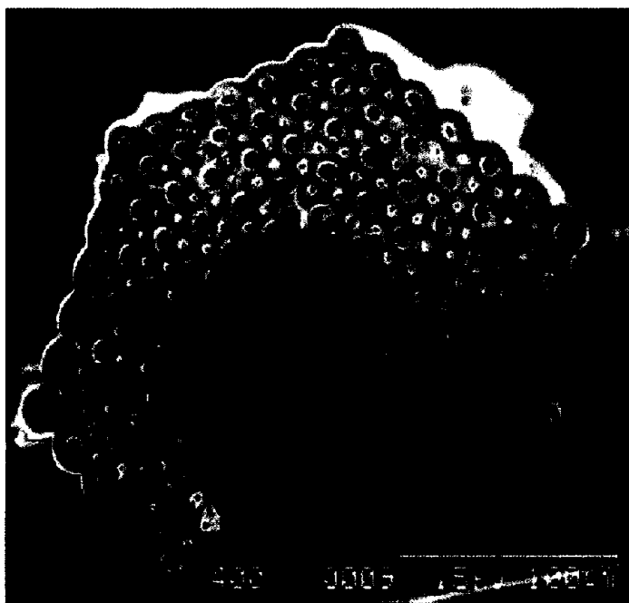
圖一、塑膠光子晶體光纖纖蕊擴孔的顯微組織
