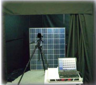
圖 2、NISSHINBO 公司之 EL 太陽能模組檢測系統。
