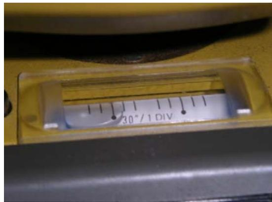
圖 5-3 虛擬物件與實際物件的比較：管狀水準氣泡
