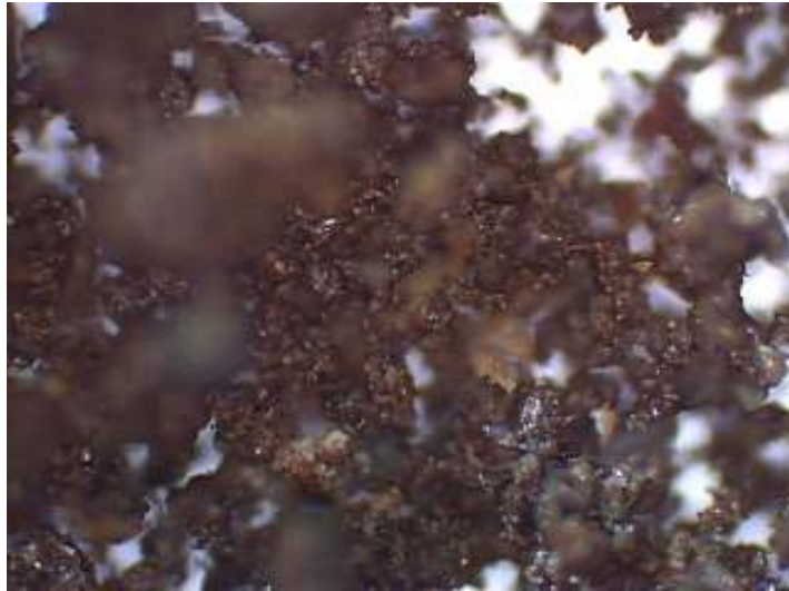
圖 4-3 污泥焚化灰電子顯微鏡掃描結果 251X
