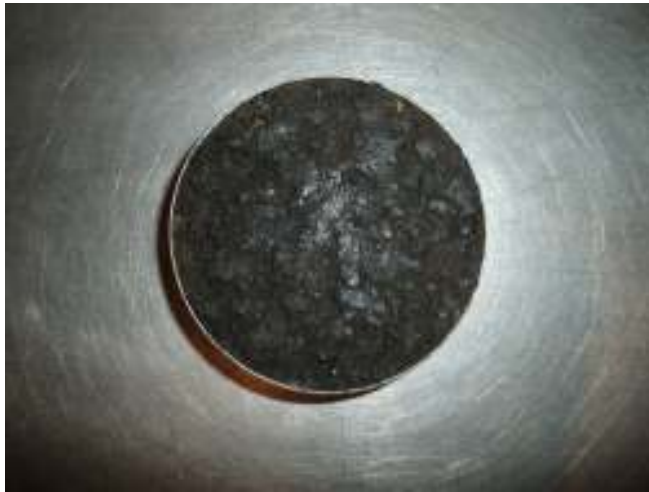
圖 3.18 直接剪力試驗用之試體
