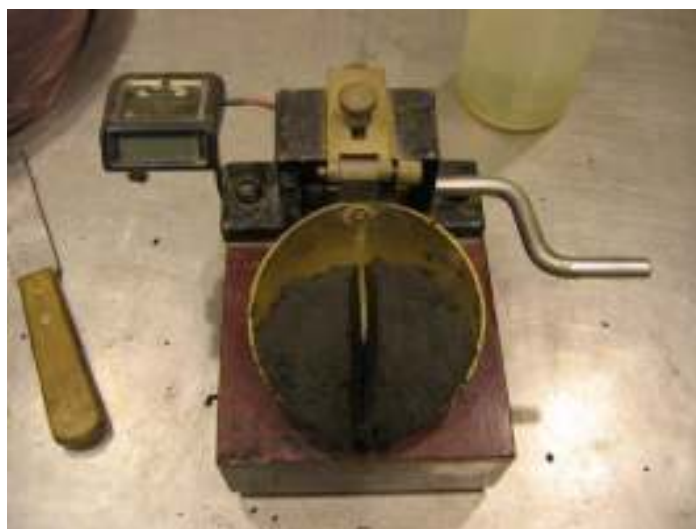
圖 3.11 液性限度試驗情形
