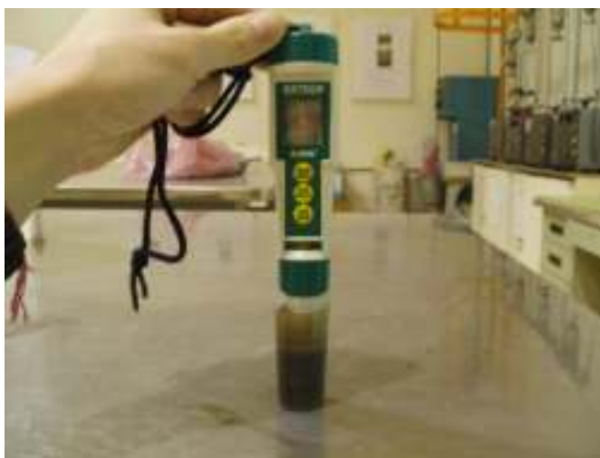
圖 3.12 試料之 pH 值量測情形
