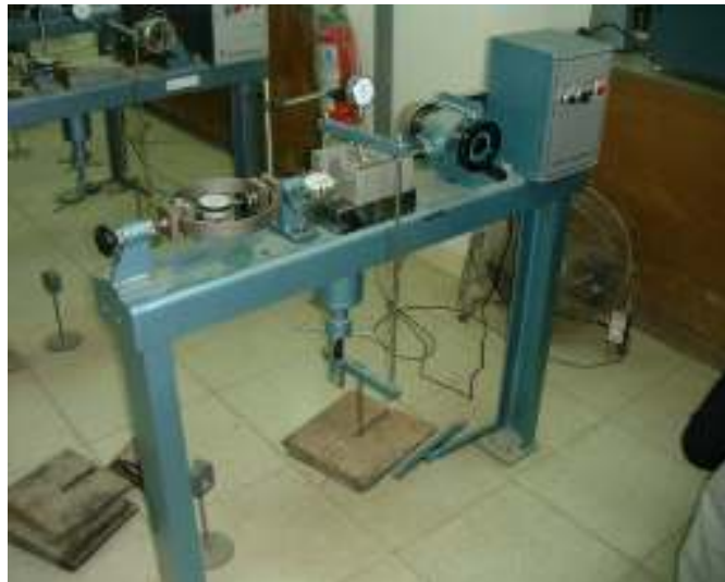
圖 3.19 直接剪力試驗進行情形
