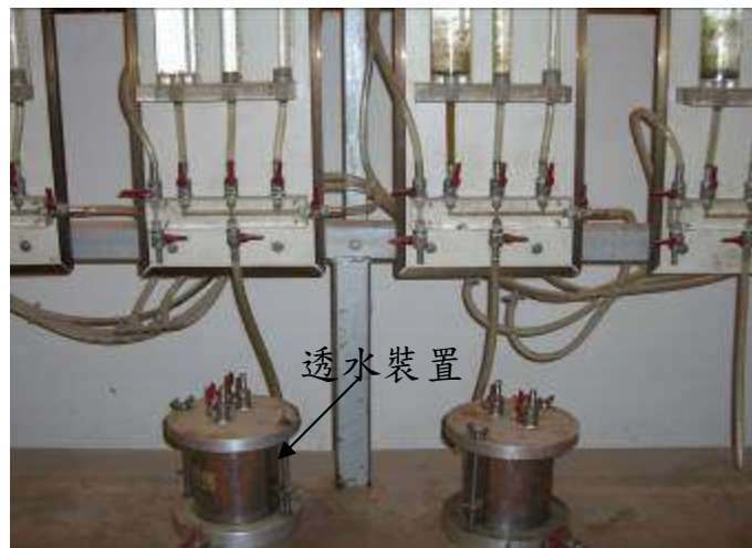
圖 3.15 室內透水試驗（變水頭法）
