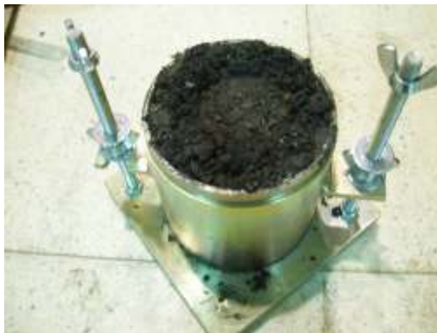
圖 3.14 試料之夯實試驗(M10S0)
