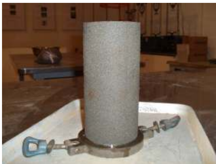
圖 3.16 處最佳夯實狀態之試體(M3S7)
