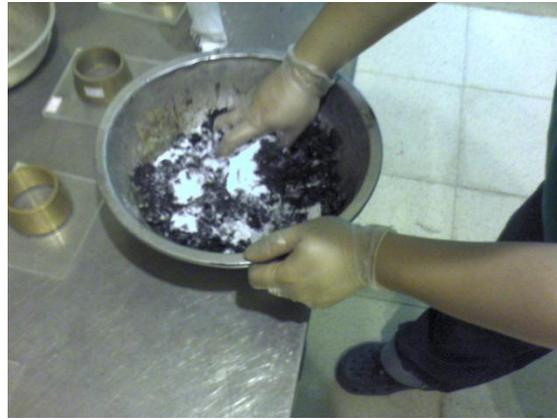
圖3 污泥-石灰之調製情形
