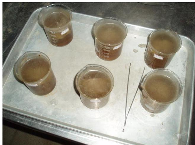
圖 7 凝結硬固污泥-石灰之浸水情形
