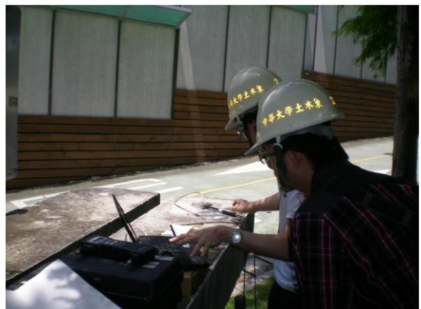
圖八 對現場小型含樁帽基樁進行敲擊反應檢測之照片二
