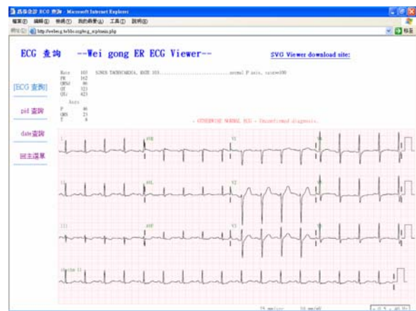
圖 13 SVG 文件在瀏覽器中以 Adobe SVG viewer 3.0 plug-in 所得之 12 導程心電圖
