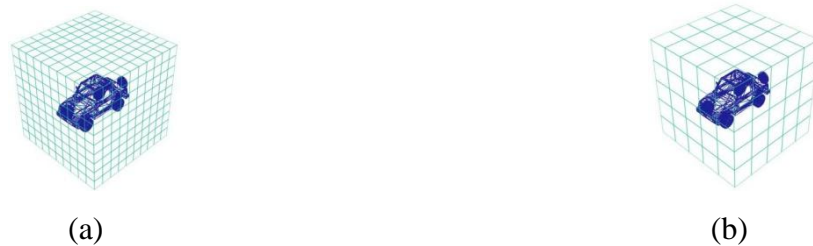
圖二十 3D 模型 (a) 切成 128 \times 128 \times 128 的微型網格 (b) 每 2 \times 2 \times 2 的微型網格，合併成一個巨型網格，形成 64 \times 64 \times 64 的巨型網格。
