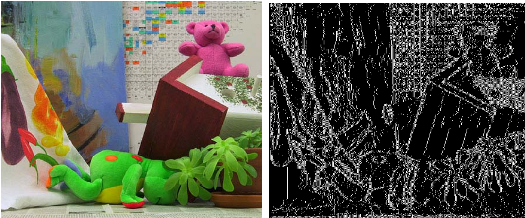
圖12 左圖為原始影像，右圖為偵測後的結果圖，白色像素點為邊緣。
