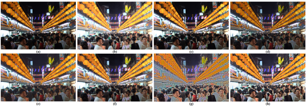
圖十一、夜間拍攝影像及應用各種方法強化之影像 (a) 原始影像 (b) 直方圖均化法(HE) (c) 曝光校正法(EC) (d) 局部伽瑪校正法(LCC) (e) 陰影校正法(SC) (f) 小波轉換影像融合法(WIF) (g) 曝光融合法(EF) (h) 我們提出之基於小波轉換之分類影像融合演算法(CVEIF)
