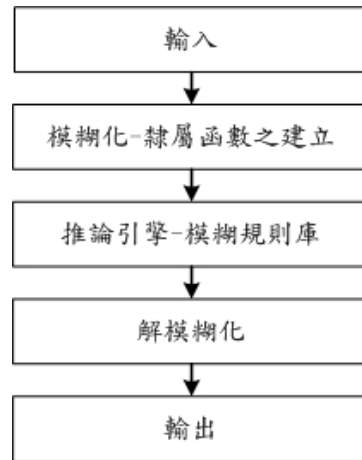
圖 4-1 模糊系統分析架構圖
