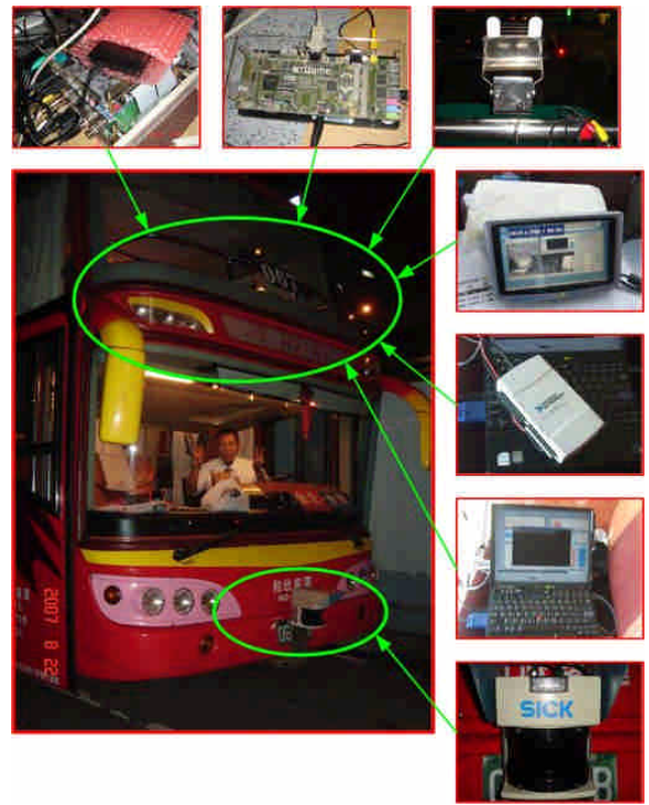
圖 14 大客車縱向防撞警示系統硬體配置圖
